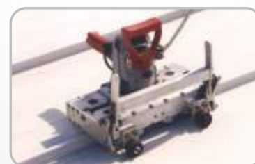
SELADORA Une de forma precisa e definitiva a telha ao clip
