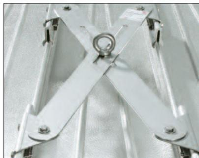
Âncora de cobertura Kalzip®, ajustável para bandejas perfiladas Kalzip®, cónicas, com espaço entre rebordos de máximo 600 mm, testadas de acordo com DIN EN 795. Folha de dados técnicos 05/02-3-004
